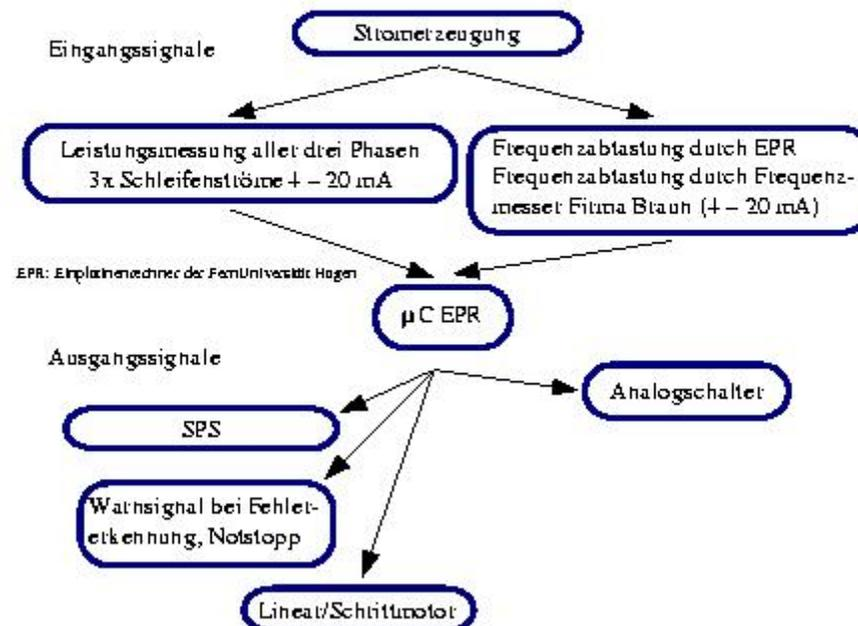
Die Ausgangssignale auf der linken Seite dienen der Steuerung/Regelung des Stromerzeugers, auf der rechten Seite zum Einlesen der Eingangssignale.
