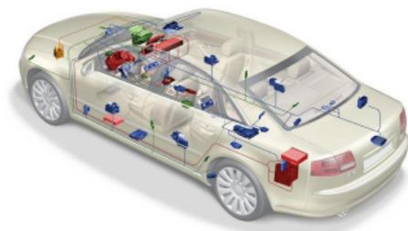
Abbildung: Verteilung von Steuergeräten in einem PKW
